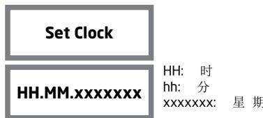
请按压“UP/DOWN”键改变小时数，按压“OK”键确认并转至修改分钟数和星期几。在确认每周星期几之后，自动进入“每周开启/关闭”程序。
