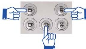
Maintenir les boutons enfoncés et placer l'interrupteur général de la machine en position 1 ou 2, indifféremment. Le maintenir enfoncé plusieurs secondes jusqu'à ce que l'écran affiche le message **RÉINITIALISATION DES DONNÉES TERMINÉE**.
