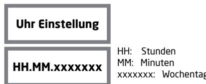
Drücken Sie die Tasten UP/DOWN um die **STUNDEN** einzustellen und bestätigen Sie mit OK, um zu den **MINUTEN** bzw. zum Wochentag weiterzugehen. Nach dem Bestätigen des Wochentags wird automatisch die Programmierung des wöchentlichen **EIN-/AUSSCHALTENS** aufgerufen.
