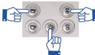
Mantenerlos pulsados y situar el interruptor general de la máquina en la posición 1 o 2, es indistinto. Mantenerlo pulsado durante varios segundos hasta visualizar en pantalla de display el mensaje **REINICIO DATOS COMPLETO**.
