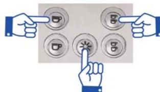
Die Tasten gedrückt halten, den Hauptschalter der Maschine auf Position 1 oder 2 stellen und mehrere Sekunden lang gedrückt halten, bis auf dem Display die Meldung **RESET ABGESCHLOSSEN** erscheint.
